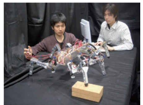
昆虫の運動知能に基づく脚型宇宙ローバの制御(上)と蝶の飛翔原理の解明(下)
