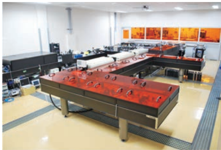
京都大学化学研究所の超高強度極短パルスレーザーシステム(T 0 -レーザー)
