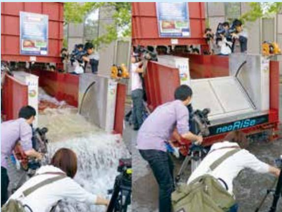
水の浮力でゲートが立ち上がる様子
