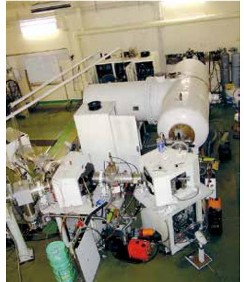
加速器の本体部分。170万ボルトの電圧でイオンを加速します。
