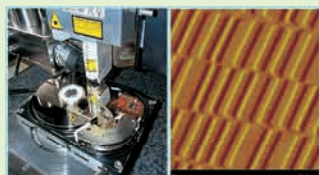
磁気力顕微鏡でハードディスクを観察している様子 ディスク上の磁気記録ビット
